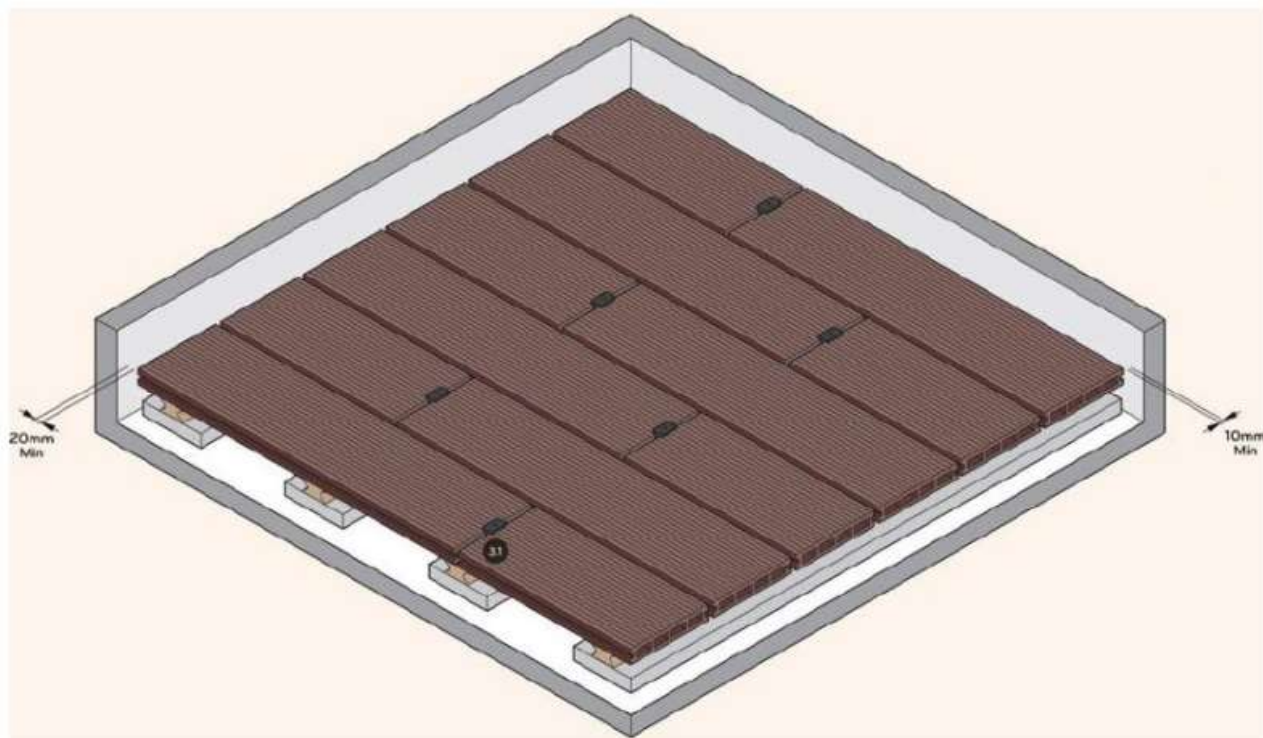
Obr. 7 – pokládka WPC desek s dodržáním dilatačních mezer
