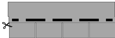
Obr. 2 - Úprava zakládacích šablon
